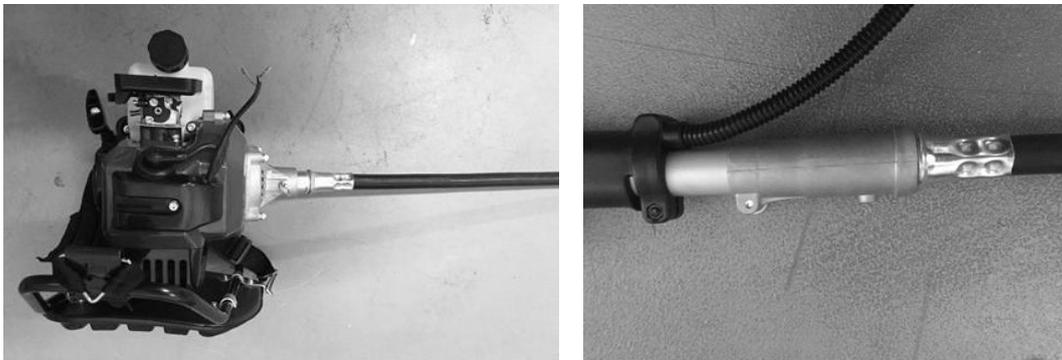
**ATTENTION :** Si l'insertion du tuyau flexible est difficile, le bout carré de l'axe flexible pourrait ne pas bien être logé dans le joint de l'arbre d'entraînement. Ne forcez pas afin d'éviter des dégâts sur l'extrémité de l'axe flexible. Répétez la même procédure jusqu'à ce que l'axe flexible et le tuyau soient bien ajustés.
