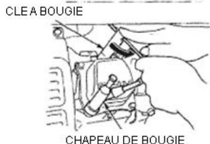
4) Inspecter visuellement la bougie. L'éliminer si l'isolateur est fissuré ou ébréché. Nettoyer la bougie avec une brosse métallique si elle doit être réutilisée.
