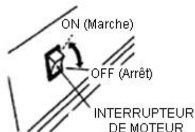
Mettre la clé en position ON une fois que le moteur a démarré. Ne pas utiliser le démarreur plus de 5 secondes à la fois. Si le moteur ne démarre pas, relâcher l'interrupteur et attendre 10 secondes avant de retenter le démarrage.
