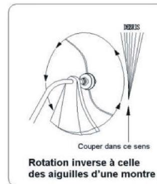
Il est recommandé d'incliner, pour tous les types de coupe, la bobine de fil afin que le contact soit établi sur la partie circulaire lorsque la bobine est en mouvement LOIN de vous et de la protection contre les débris. (Cf. croquis correspondant). Ceci aura pour résultat de dévier les déchets LOIN de vous.
