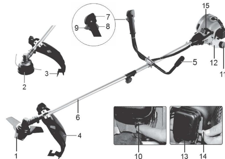
1. **LAME:** Lame à 3 dents pour l'herbe et les opérations de désherbage et débroussaillage. Un harnais et une protection métallique sont nécessaires pour toute manipulation impliquant l'usage de la lame.
