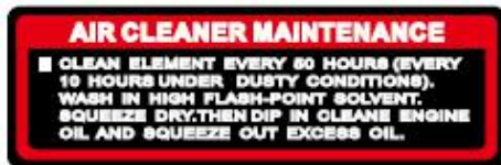
Instructions pour la maintenance du filtre à air
